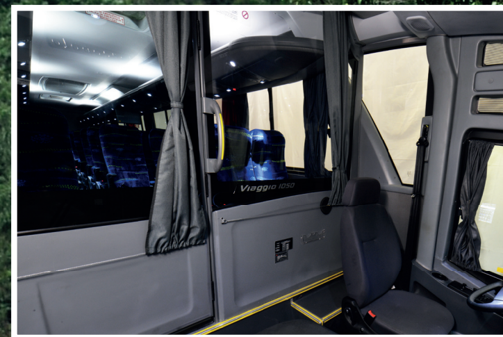
Pared de separación de la cabina completa con puerta (opcional).
